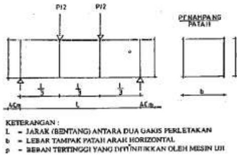
Gambar 1. Perletakan dan Pembebanan Balok Uji (Sumber: SNI 03-4431-1997)
