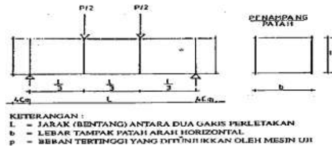
Gambar 1. Perletakan dan Pembebanan Balok Uji (Sumber: SNI 03-4431-1997)
