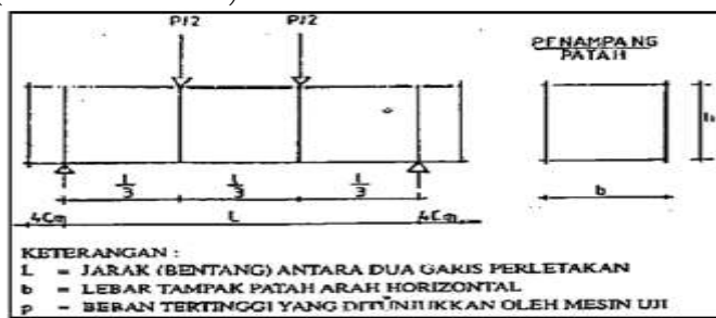
Gambar 1. Perletakan dan Pembebanan Balok Uji (Sumber: SNI 03-4431-1997)
