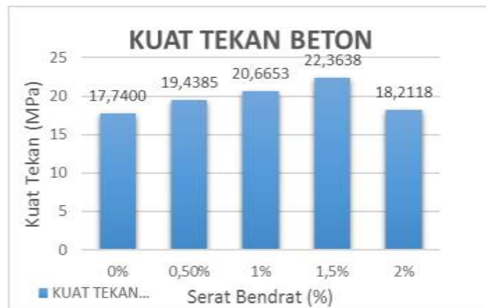
Gambar 1. Diagram Hubungan Kuat Tekan Beton dengan Persentase Serat Bendrat
