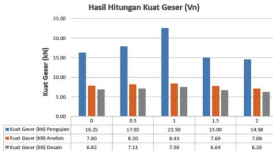
Gambar 2. Diagram Perbandingan Kuat Geser Hasil Pengujian, Analisis, dan Desain
