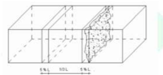
**Gambar 4.** Balok yang patah di luar 1/3 bentang tengah dan garis patah pada kurang dari 5% dari bentang tengah (SNI 4431-2011).
