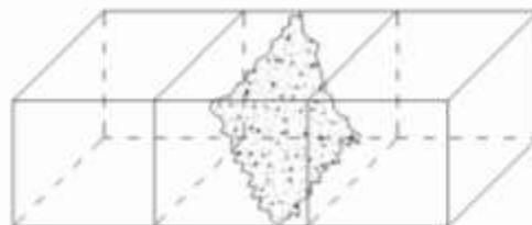
**Gambar 3.** Balok patah pada 1/3 bentang tengah (SNI 4431-2011).
