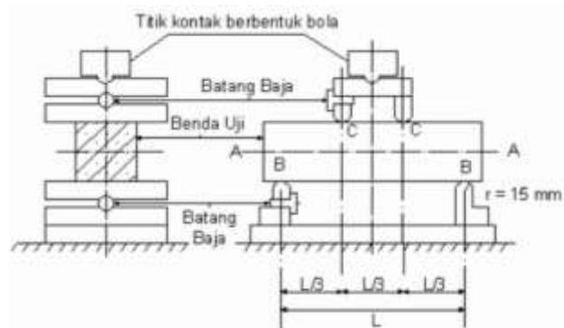
**Gambar 1.** Benda Uji, Perletakan dan Pembebanan (SNI 4431-2011).
