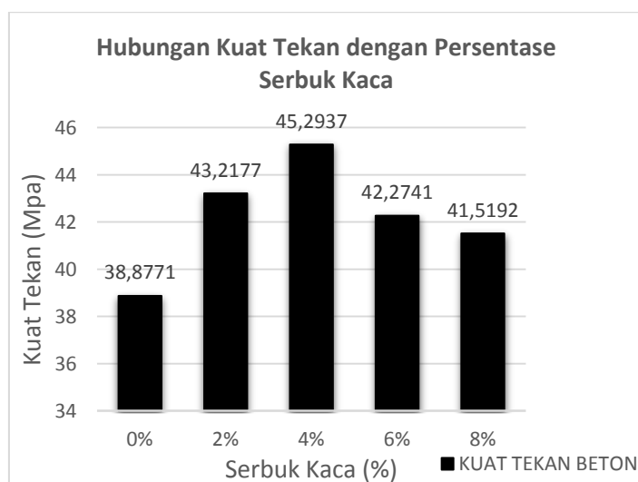
Gambar 1. Diagram Hubungan Kuat Tekan Beton dengan Persentase Serbuk Kaca
