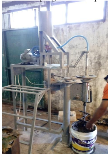
Gambar 2. Soil cement mixing dalam skala laboratorium
