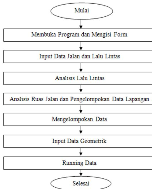
**Gambar 5** Diagram Alir Perhitungan Metode SDPJL
