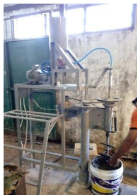
Gambar 2. Soil cement column dalam skala laboratorium
