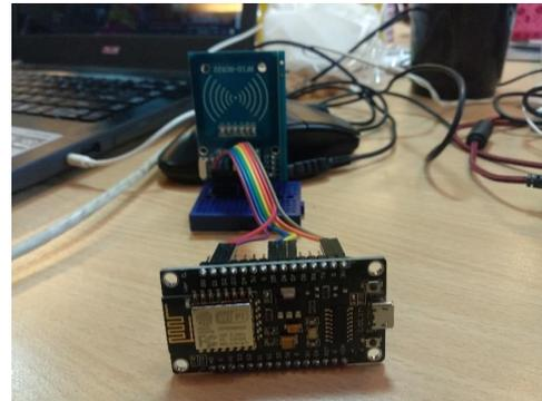
**Gambar Rangkaian RFID dengan NodeMCU**
