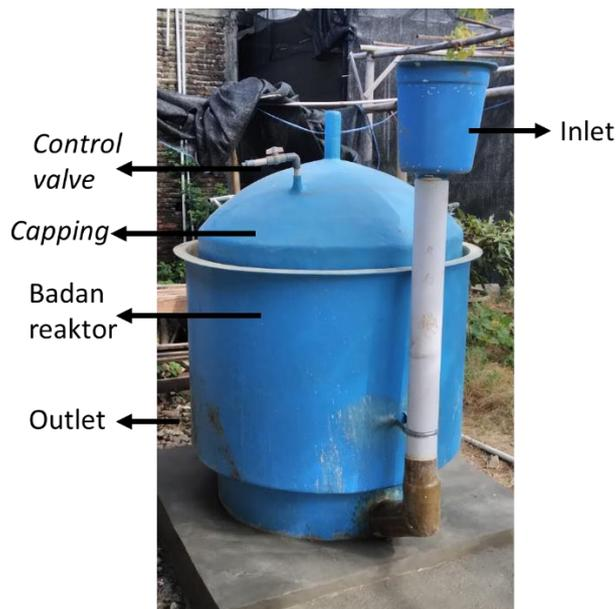
Gambar 4. Bagian-bagian reaktor biogas
