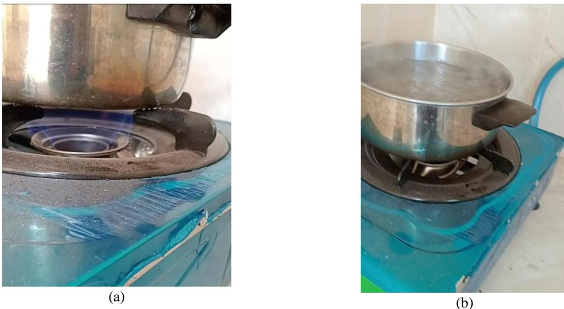
**Gambar 7. Uji fungsi (a) api biru hasil dari biogas dan (b) kemampuan api dari biogas untuk memasak**
