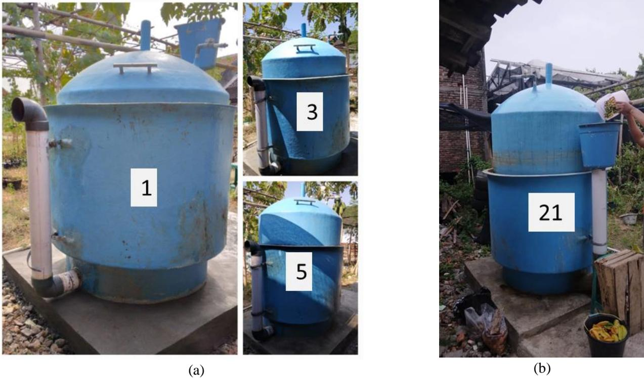
**Gambar 6. Perubahan ketinggian capping karena tekanan gas yang terbentuk pada hari ke (a) 1, 3, 5 dan (b) 21.**
