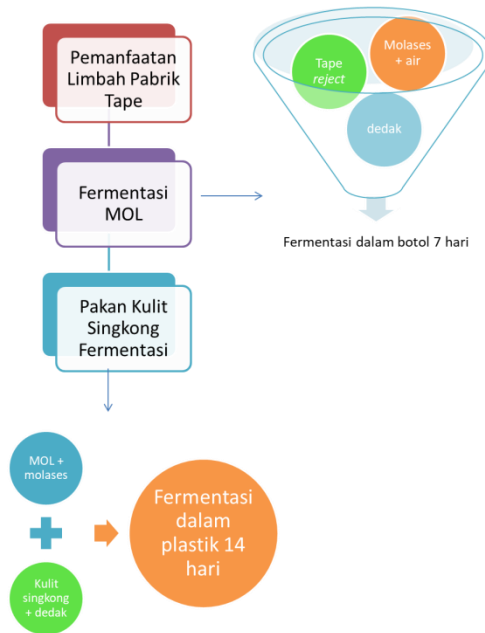
Gambar 3. Cara pembuatan MOL dan pakan fermentasi
