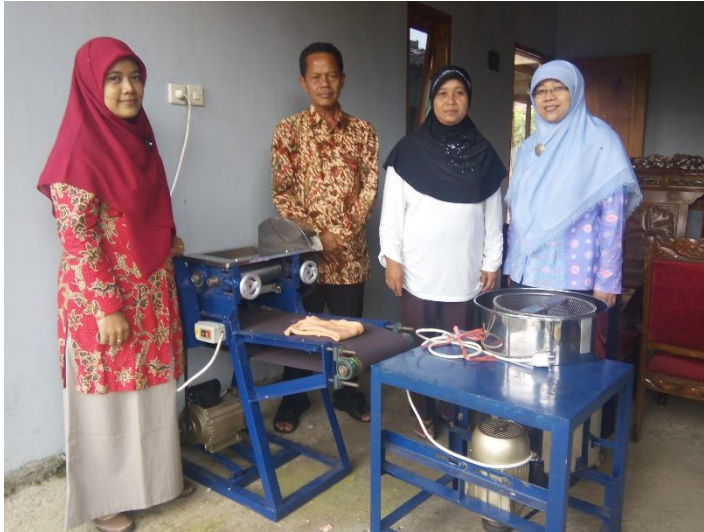
Gambar 3. Introduksi spinner mampu meningkatkan mutu produk sekaligus mempersingkat waktu penirisan pangsit
