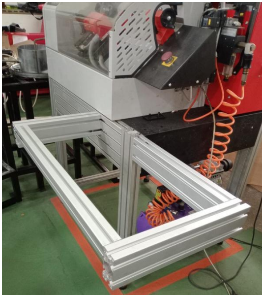
a. Konstruksi penopang keyboard external Sinumerik 840D b. Bracket untuk pemasangan display 11 inci.
