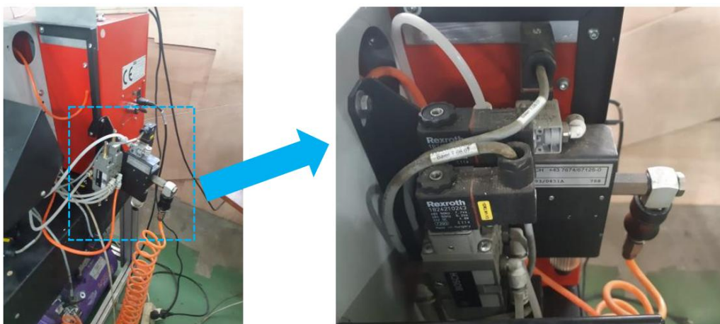
Gambar 3 Katup kendali arah aliran pada sistem pneumatik di mesin Emco Concept Turning 55.
