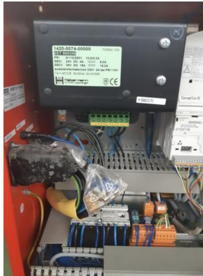
Gambar 2 Main power supply dan pegendali utama mesin CNC Emco 55.
