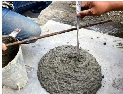
Gambar 3. Pengujian slump flow
