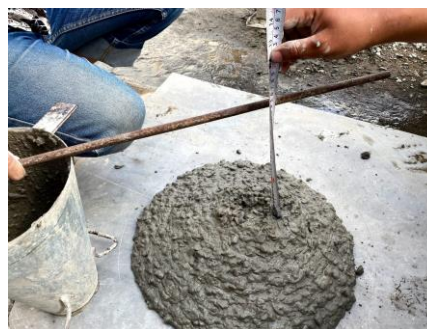
Gambar 3. Pengujian Slump Flow
