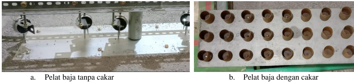
Gambar 1 Model pelat uji baja tanpa cakar dan dengan cakar
