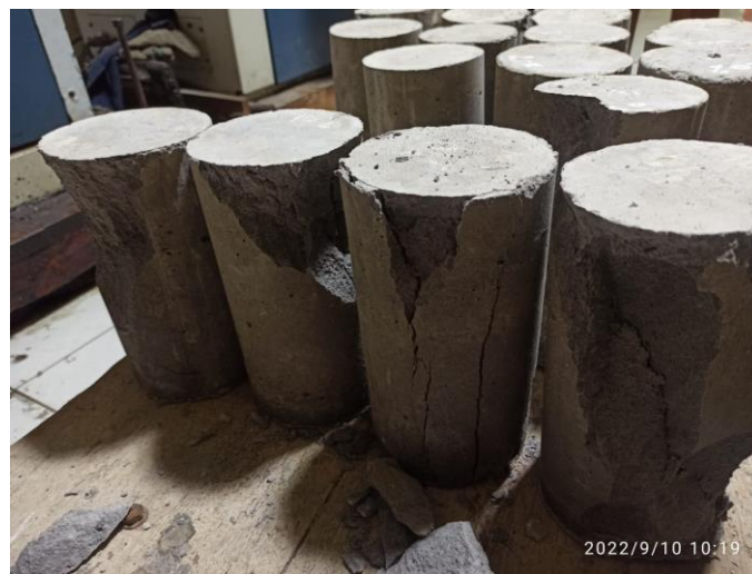
Gambar 3. Kerusakan Mortar setelah di Uji
