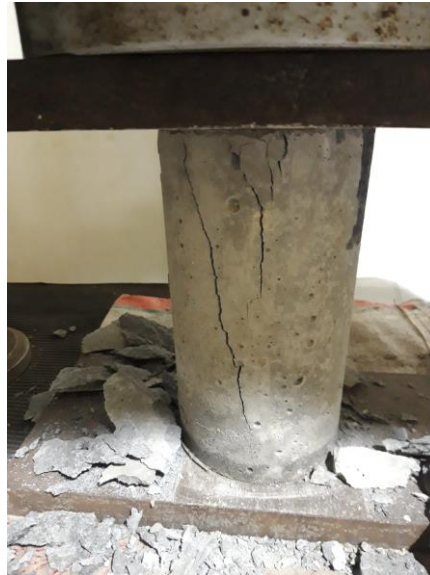
Gambar 2. Pengujian Silinder Mortar
