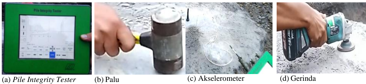
Gambar 12. Dokumentasi Peralatan Uji PIT (Dok. Penulis, 2022)
