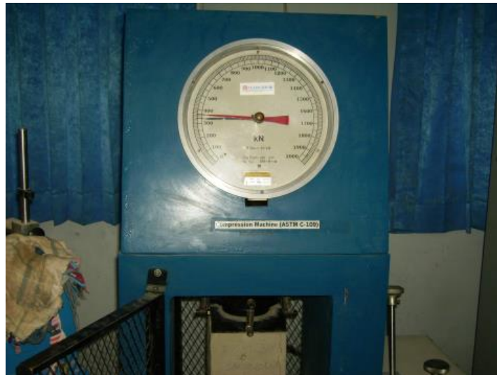
Gambar 3. Uji tekan kubus beton
