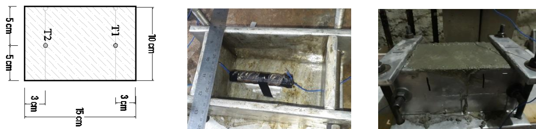
Gambar 1. Pemasangan thermocouple untuk pengujian pengukuran permukaan beton
