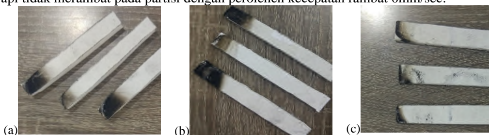
Gambar 7. Hasil Uji Bakar pada (a) Gypsum ; (b) Kalsiboard; (c) Smart-Partisi
