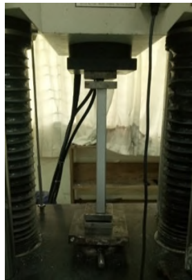
Gambar 8. Pengaturan uji tekan spesimen
