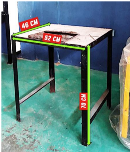
Gambar 1. Meja Las dan Meja Mesin Las pada Laboratorium Pengelasan Pendidikan Teknik Mesin UNS
