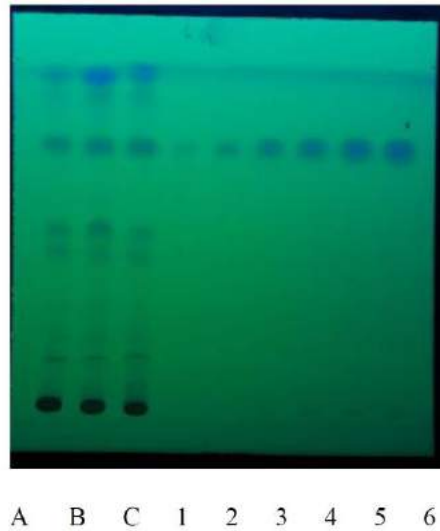
Gambar 2. Visualisasi plat KLT ekstrak kemukus berasal dari Kulonprogo (A), Magelang (B), dan Wonosobo (c) dan variasi standar kubebin (1, 2, 3, 4, 5, dan 6 µL) (1-6) di bawah sinar UV 254 nm menggunakan fase diam silica gel GF254 dan fase gerak diklorometan:etil asetat (8:2).
