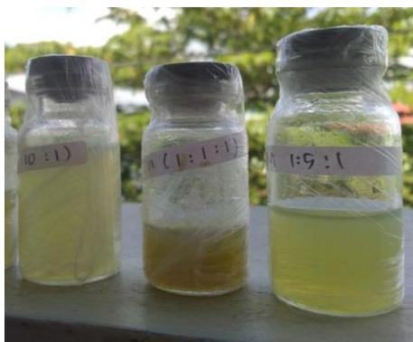
**Gambar 2.** Hasil fisik larutan nanopartikel dengan masing-masing perbandingan ekstrak etanol daun salam (*Syzygium polyanthum*): kitosan: NaTPP secara berurutan yaitu kiri (1:10:1), tengah (1:1:1) dan kanan (1:5:1).
