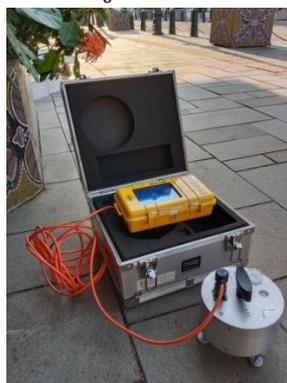
**Figure 2.** MAE S3S Vibralog Seismometer Tool
