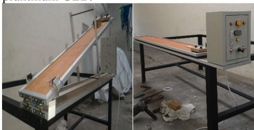
Gambar 1. Realisasi Alat *Ticker Timer* dengan Penghitung Waktu Otomatis Menggunakan *Timer* LE8N *Series*
