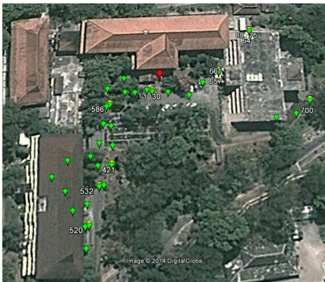
Gambar 4 Hasil survey jaringan 2G/3G di Fakultas MIPA menggunakan MobiLog®
