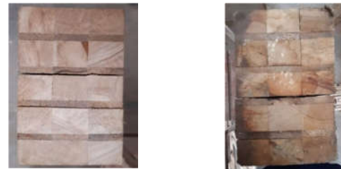
Gambar 4. Pola kegagalan geser balok laminasi jabon bambu
