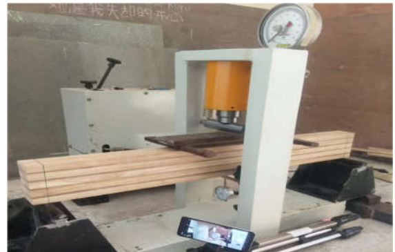
Gambar 2. Setting pengujian lentur balok laminasi.
