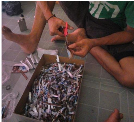
Gambar 5. Pembuatan serat plastik kemasan susu.
