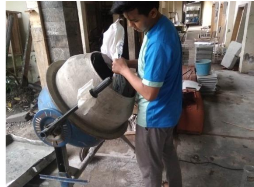
Gambar 6. Pembuatan benda uji kuat tekan dan kuat lentur beton.
