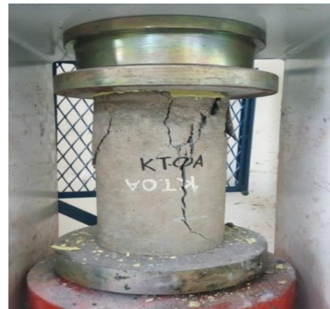
Gambar 9. Pengujian kapasitas tekan silinder beton
