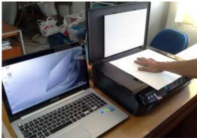
**Gambar 1.** Sistem *Thermochromic Liquid Crystal* menggunakan *scanner*
