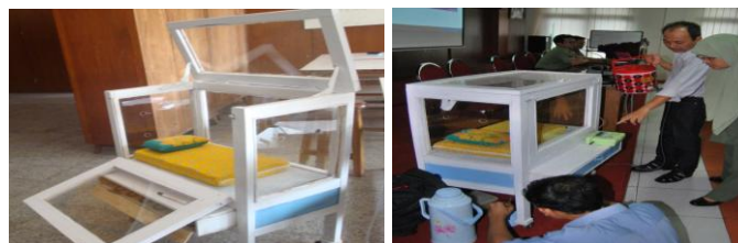
Gambar 2. (color online) Bukaan ganda inkubator bayi produksi sendiri yang memudahkan akses penanganan bayi. Kotak kecil yang ditunjuk adalah unit tambahan pemantau suhu dan kelembaban
