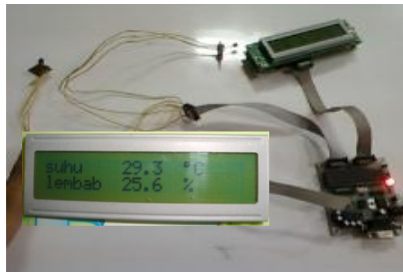
Gambar 4b. (color online) Rangkaian unit pemantau suhu dan kelembaban untuk inkubator secara fisik. Gambar inset memperlihatkan contoh tampilan pembacaan nilai suhu dan kelembaban
