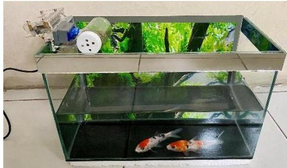
**Gambar 6. Pemasangan *Prototype* Perangkat Otomatisasi Pakan Ikan pada Akuarium Tampak Depan**
