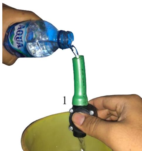
Gambar 8. Pengujian *Waterflow Sensor*
