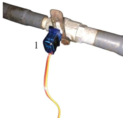
Gambar 9. Pengujian Motor Servo SG-90
