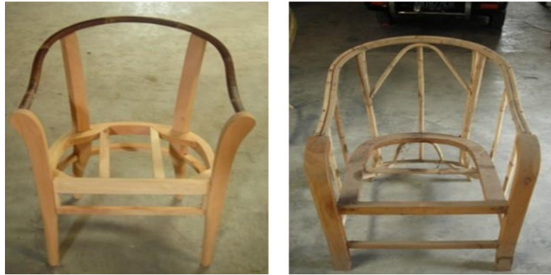
Gambar 11. Rangka kursi gabungan dari bahan kayu dan batang rotan) Sumber : dokumen pribadi
