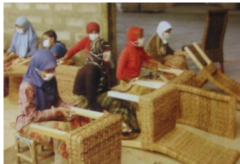
Gambar 5. Para pekerja di salah satu pabrik mebel anyam melakukan pekerjaan pengamplasan sebelum mebel di -finishing ) Sumber : dokumen pribadi
