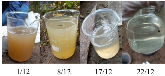
Gambar 2. Visual outlet ST 600 air limbah domestik rumah Bapak Wahyudi
