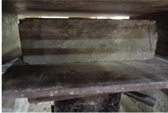
**Gambar 3.** Pengujian Kuat Tekan menggunakan mesin kuat tekan CTM
