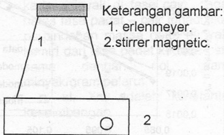
Gambar 2. Skema rangkaian alat ekstraksi.
