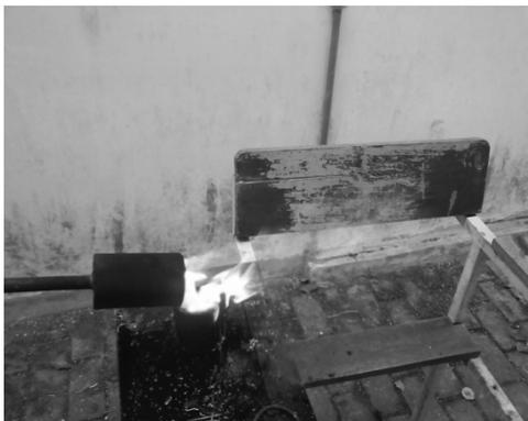
Gambar 3. Lidah Api yang Terbentuk pada Pembakaran Gas Produser
