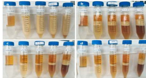
Gambar 10. Uji kelakuan fasa surfaktan asam oktil lignosulfonat dengan variasi konsentrasi (a) hari ke-0 (b) hari ke-2 (c) hari ke-3 dan (d) hari ke-7
