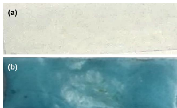
Gambar 4. Warna membran CTS/TPP sebelum (a) dan setelah (b) direndam dalam larutan Cu(II) 10 ppm.
