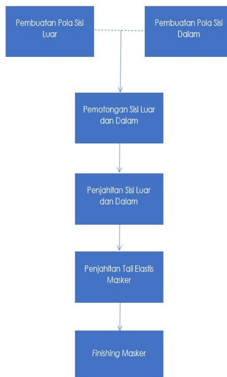
Gambar 1. Alur Proses Pembuatan Masker Kain Perca
