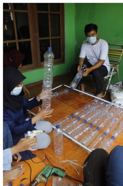
Gambar 1. Pembuatan *Prototype* Aquaponik Botol Bekas
