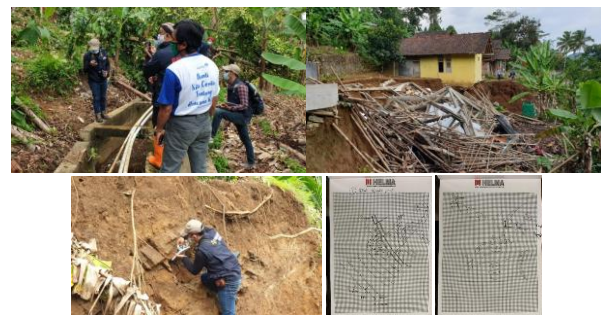
Gambar 3. Pelaksanaan kegiatan survei dan identifikasi geologi pada jalur-jalur penurunan tanah dan patahan struktur akibat longsor
