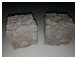
Gambar 4.6 Paving Block 50% Abu Serbuk Kayu Jati dan 50% LDPE
