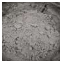
Gambar 4.9 Paving Block 50% Abu Serbuk Kayu Jati, 20% Semen, dan 30% LDPE
