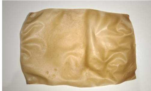
Gambar 3.1 Bioplastik Dari Kulit Pisang Kepok.
