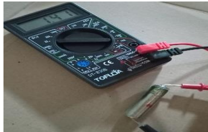
Gambar 5. Proses Pengukuran Tegangan
