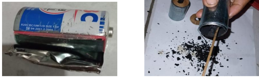
(a) (b) Gambar 3. (a) Proses Pengelupasan Kulit Baterai, (b) Pengeluaran Serbuk Karbon
