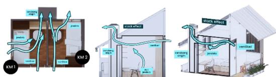
Gambar 18. Penerapan Cerobong Angin untuk *Passive Cooling*
